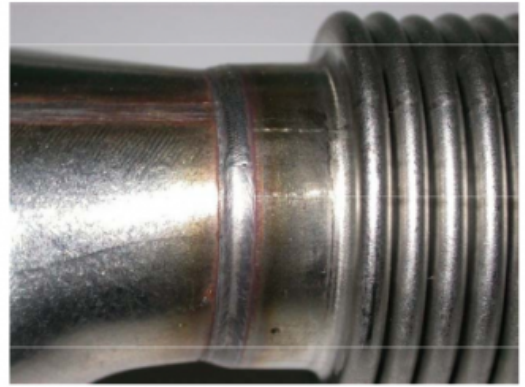
Laserschweißung, Scanbreite 1,8 mm
